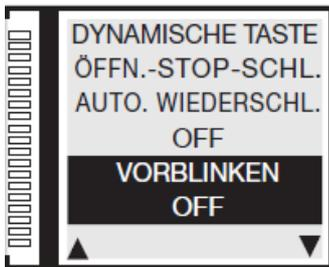
Aktiviert das Vorblinken einer an Klemme 12 – LP - angeschlossenen Blinkleuchte.
