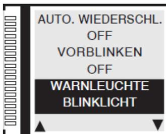
Definiert die Funktion der an Klemme 12 - LP - angeschlossenen Blinkleuchte.
